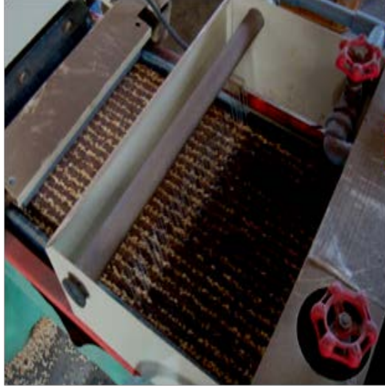
Resim 1.11 : Viyoller otomatik tohum ekme makinesi
